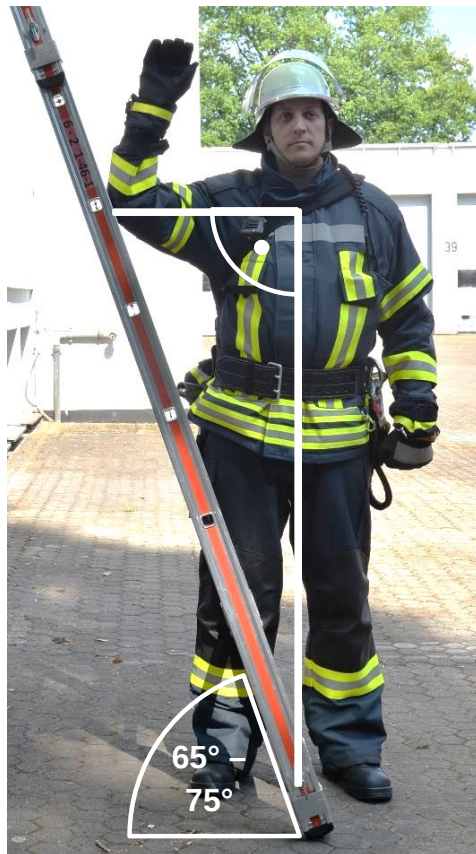
Abbildung 2: Überprüfen des Anstellwinkels
