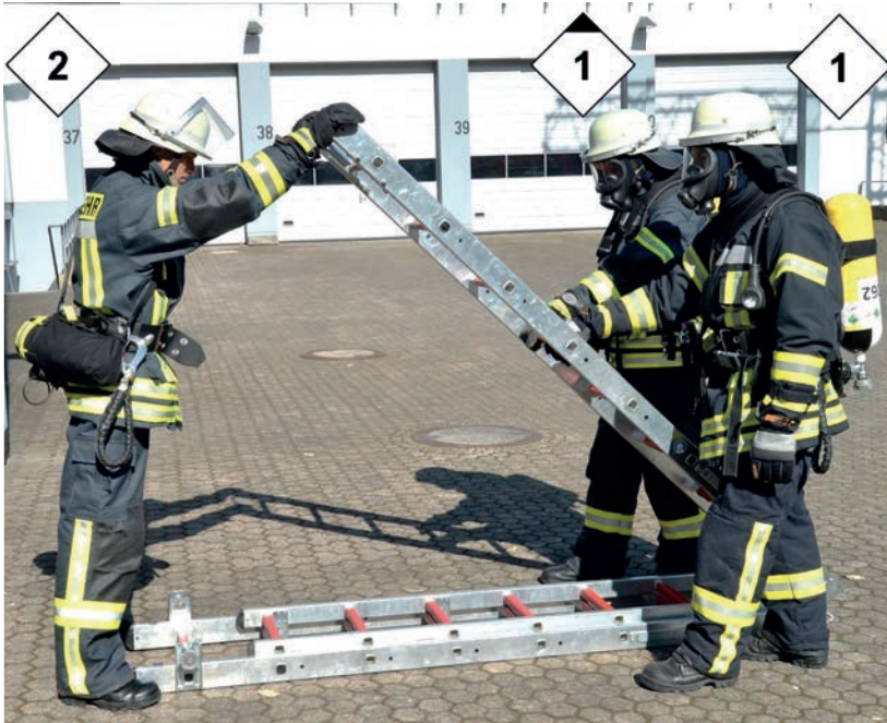
Abbildung 32: Aufklappen der Multifunktionsleiter
