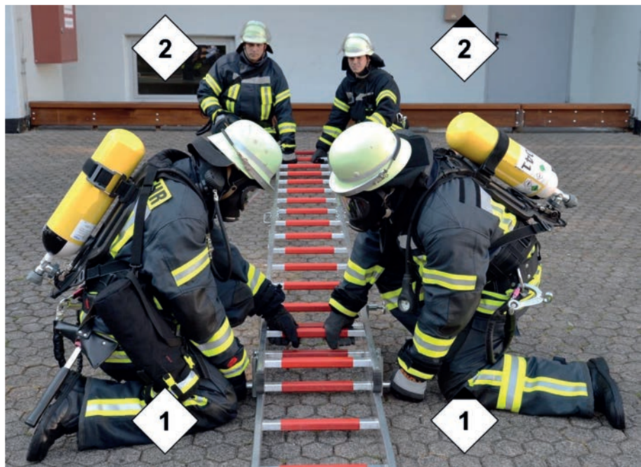
Abbildung 41: Verbinden der Multifunktionsleitern
