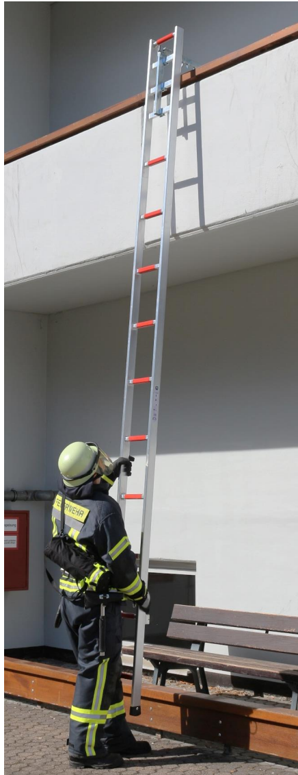
Abbildung 27: Einhängen der Hakenleiter
