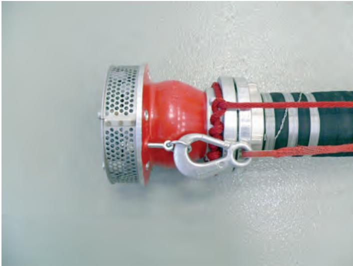
Die Ventilleine wird mit dem Karabinerhaken in das Auge oder den Ring des Rückschlagorgans eingehängt.
