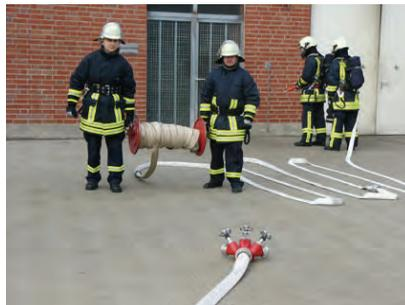
Bei der tragbaren Schlauchhaspel muss die Schlauchleitung von unten abrollen.
