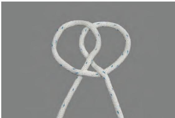
Der Mastwurf ist ein Befestigungsknoten. Er dient zum Anschlag, beim Selbstretten, zum Halten und zum Auffangen.
