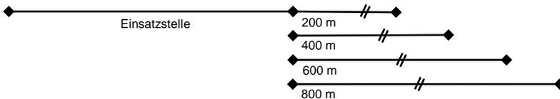
Der Beginn der Absicherung richtet sich nach den möglichen Höchstgeschwindigkeiten herannahender Verkehrsteilnehmer. In Streckenbereichen ohne Geschwindigkeitsbegrenzung hat der Beginn der Absicherung 800 Meter entgegen der Fahrtrichtung vor der Einsatzstelle zu erfolgen. Die Zeichen sollen nach 200 Metern in Fahrtrichtung wiederholt werden.
