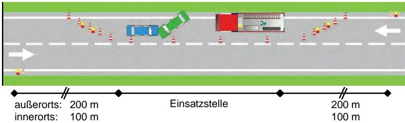
Bei unübersichtlicher Straßenführung (Kurven, Kuppen, sonstige Sichtbehinderungen) sind gegebenenfalls größere Sicherheitsabstände zu wählen. Das Warngerät ist so weit vor dem Sichthindernis aufzustellen, dass es bei Annäherung bereits auf Entfernung erkannt wird.
