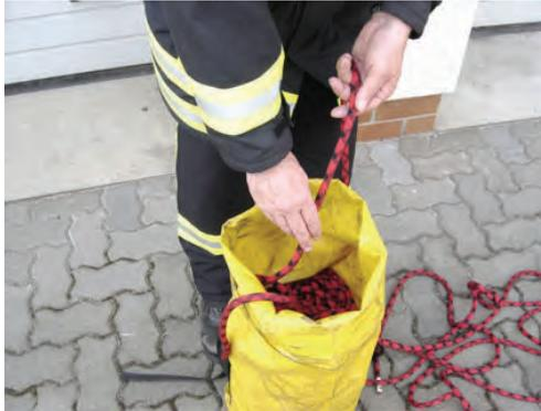
Das zuerst eingelegte Ende wird am Seilsack z. B. durch einen Mastwurf befestigt. Danach erfolgt das Einlegen des Kernmantel-Dynamikseils. Der einfache Achterknoten wird zweckmäßigerweise in das freie Seilende eingebunden und obenauf gelegt.
