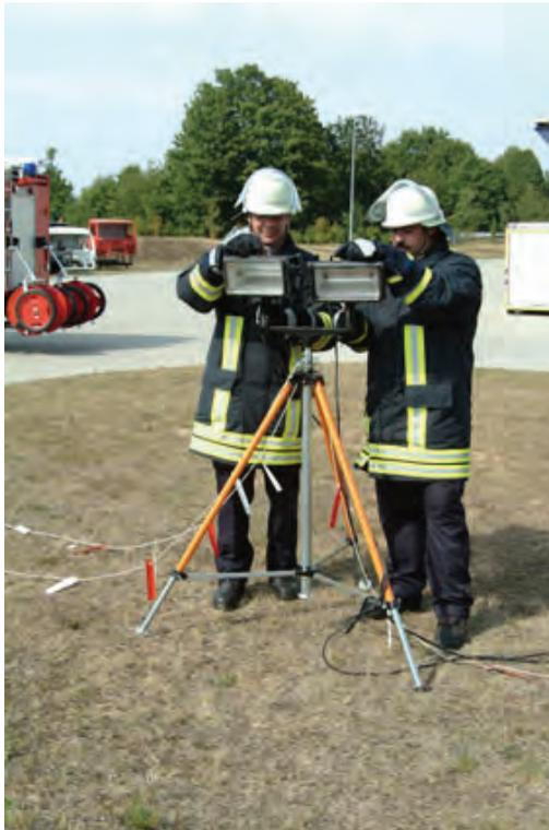
Flutlichtstrahler, Aufnahmebrücke und Stativ werden miteinander verbunden, der Abstrahlwinkel der Flutlichtstrahler eingestellt und das Stativ im Regelfall ganz ausgeschoben. Die Sturmverspannung wird zuvor am Stativ befestigt.
