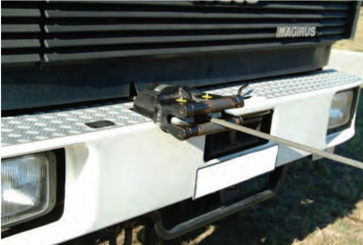
Beim Einziehen des Zugseils dürfen bestimmte Seiten- und Höhenwinkel nicht überschritten werden. Angaben hierzu sind aus den Hinweisen des Herstellers zu entnehmen.
