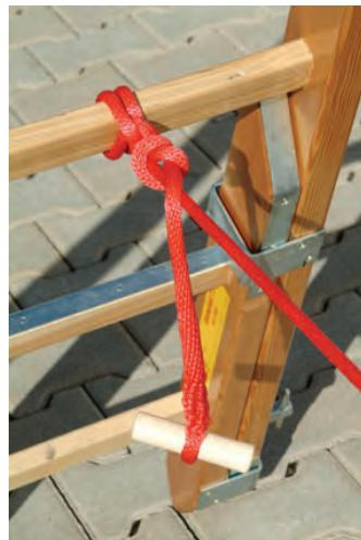
Die Standsicherheit der Leiter und die Verbindung der Leiterteile untereinander sind zu beachten. Die Verbindung erfolgt in der Regel mit Mehrzweckkleinen.
