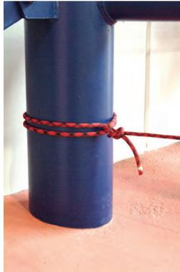
In das angeschlagene Kernmantel-Dynamikseil wird mit einem Achterknoten eine Schlaufe gebunden (vergleiche hierzu Abbildung 1 im Kapitel 17.1.1). In diese Schlaufe wird ein HMS-Doppelverschlusskarabiner eingeklinkt, in dem der Halbmastwurf eingelegt wird.
