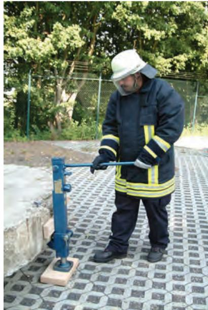
Die Fußplatte der Winde wird in der Regel auf eine Fußlagerplatte (Zubehör) und/oder eine Unterlage aus Holz gesetzt, die dem sicheren Stand dient.
