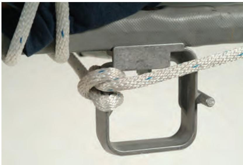
Danach werden beide Leinenenden durch mehrere halbe Schläge oder je einen Mastwurf an den Griffen befestigt.
