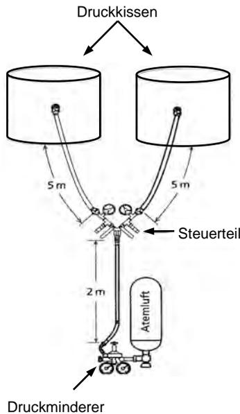
Das Hebekissensystem besteht aus Druckkissen mit Füllschlauch, einer Druckluftflasche mit Druckminderer, einem Luftschlauch zur Verbindung von Druckminderer und Steuerteil und dem Steuerteil mit Kupplungen zum Anschluss für Luftschlauch und Füllschläuche. Vom Steuerteil können ein oder zwei Druckkissen betrieben werden.
