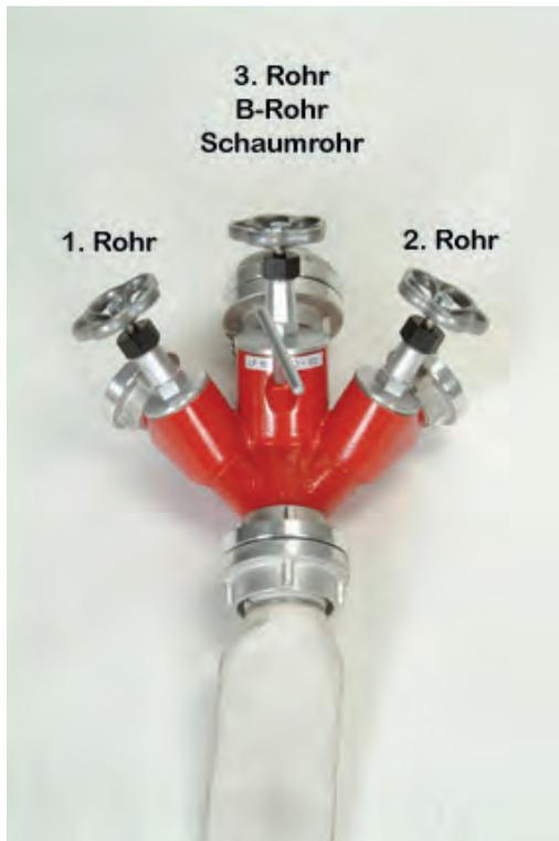
Der Sicherheitstrupp sollte seine Schlauchleitung am mittleren Abgang des Verteilers (3. Rohr) anschließen, sofern dieser nicht durch ein B- oder Schaumrohr belegt ist.
