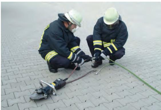
Zwischen der motorgetriebenen Hydraulikpumpe mit Elektroantrieb und dem Stromerzeuger wird eine Leitungsverbindung (Stromversorgung) aufgebaut und die Hydraulikpumpe an diese Leitung angeschlossen. Nach Inbetriebnahme des Stromerzeugers ist das Gerät damit einsatzbereit.
