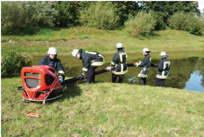
Die Saugleitung wird zunächst durch den Maschinisten an die Pumpe angekuppelt. Danach erfolgt das Zu-Wasser-Bringen und das Positionieren der Saugleitung im Gewässer. Sie soll genügend tief und entgegen der Fließrichtung liegen. Anschließend wird die Halteleine unter Spannung an einer geeigneten Stelle befestigt.
